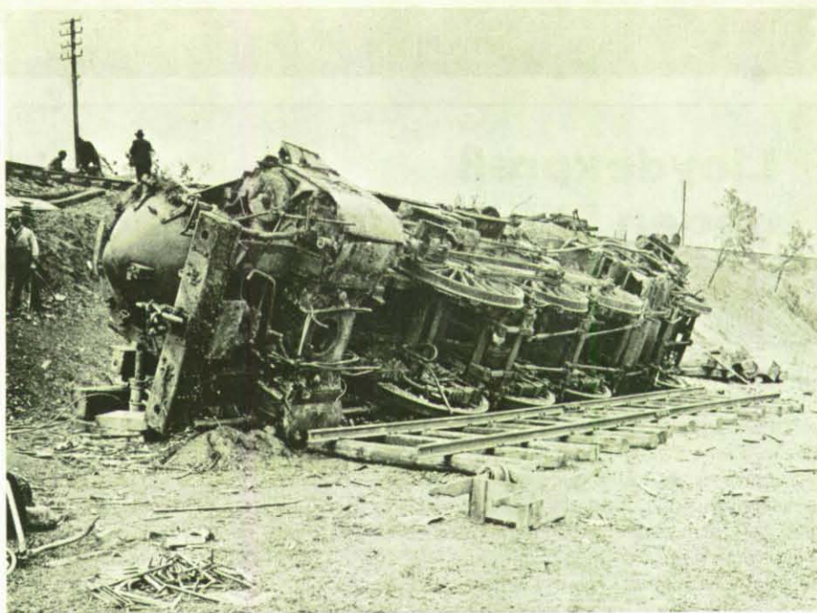
Bei dem Sturz der Lokomotive platzten die Kesselrohre, so daß der Dampf der Maschine in die Waggons eindrang und viele Fahrgäste verbrühte.
