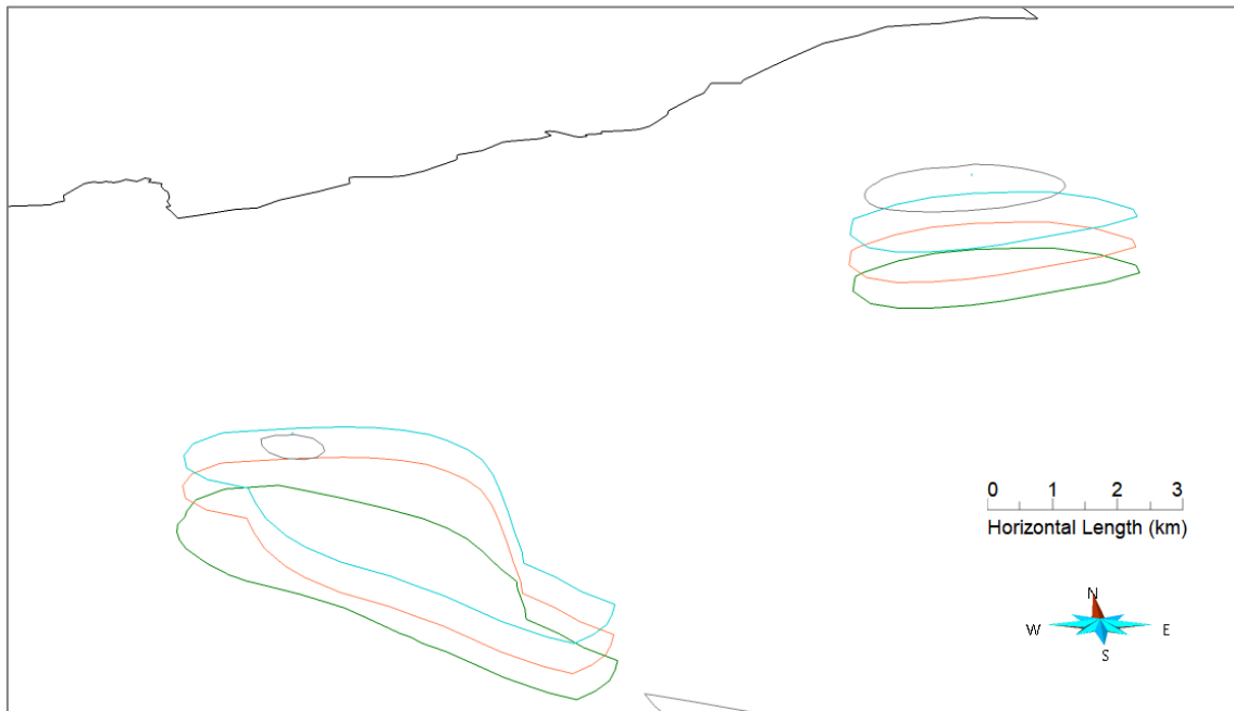
Abbildung 12: Ausschnitt der Datengrundlage für die Modellierung der Salzstrukturen im Norden von Sachsen-Anhalt. Niveauschnitte in 500 m u. NN (grau), 1000 m u. NN (blau), 1500 m u. NN (orange) und 2000 m u. NN (grün) sowie Kulminationspunkte lagen für die Bearbeitung vor. Die Landesgrenze ist in schwarz dargestellt und die Blickrichtung nach Norden.
