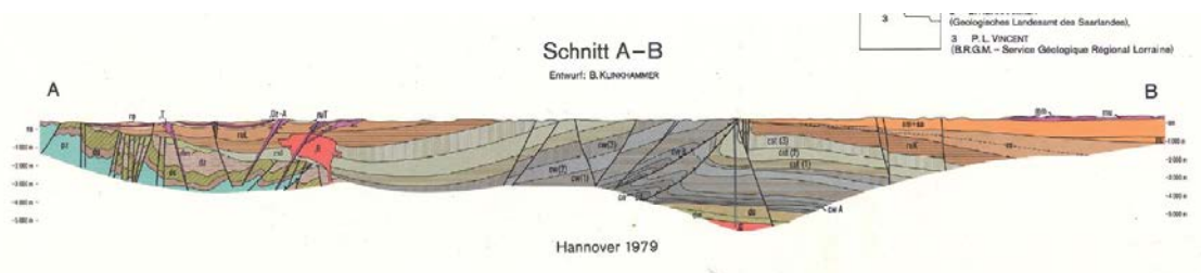
Abbildung 124 Schematischer geologischer Schnitt durch das Saar-Nahe-Becken (GÜK200 – CC 7102 Saarbrücken); Schnittlage Nordwest-Südost. Die Forschungsbohrung Saar 1 im Zentrum des Saar-Nahe-Beckens durchteuft Einheiten des Karbon und Devon und endet in Granit (in Rot dargestellt); Grundgebirge im NE des geologischen Schnitts sind devonische Einheiten (Tonschiefer, Sandsteine und Grauwacken).
